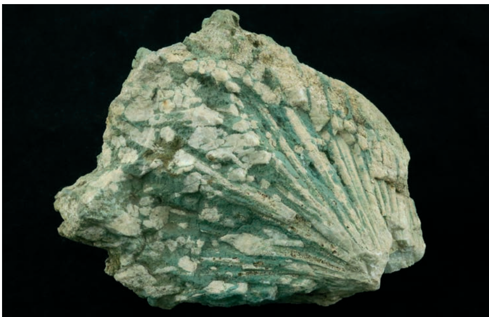
Obr. 6. Sloupcovité šestiboké kalcity v zeleném jílovém minerálu z lokality Čarodějka u Kunína. Velikost 10×8 cm. Foto J. Jirásek, 2023.
