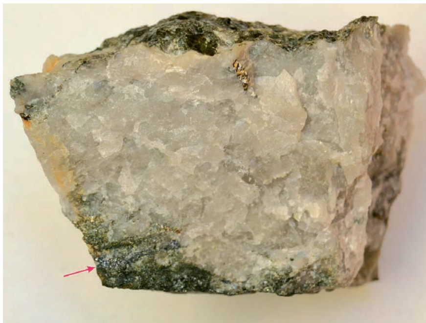
Obr. 1. Makrofoto vzorku studované mineralizace. Křemenná žilovina obsahuje drobné vtroušeniny pyritu a pyrrotinu a při spodním okraji žily při kontaktu s okolní horninou i drobný molybdenit (šipka). Šírka vzorku 7 cm. Foto J. Ulmanová.
