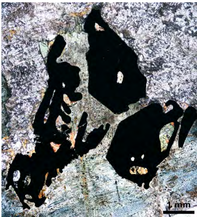
Obr. 2. Opakní kostrovitá zrna ilmenitů s tenkými lemy titanitu v saussuritizovaném plagioklasu a přeměněném amfibolu; pozorované bez analyzátoru.
