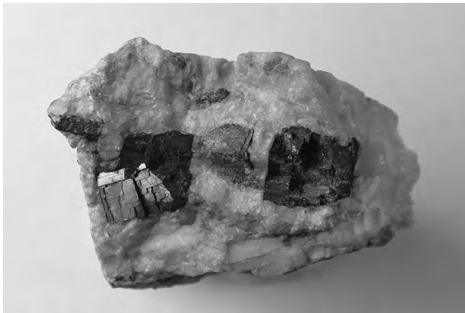
Obr. 9. Nedokonale krystalizovaný galenit v křemen-kalcitové žilovině, Vladislav u Třebíče; velikost vzorku 4 × 3,5 cm. Fig. 9. Imperfect crystals of galena in quartz-calcite gangue, Vladislav near Třebíč; sample size 4 × 3.5 cm.
