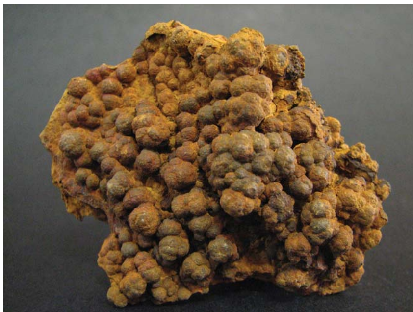
Obr. 6. Rezavě hnědý ledvinovitý agregát goethitu. Velikost vzorku 6×4,5 cm, foto J. Jirásek. Fig. 6. Rusty brown botryoidal aggregate of goethite. Size 6×4,5 cm, photo J. Jirásek.
